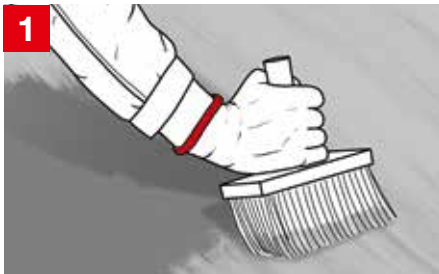
Mouiller le support à l'humidité mate
