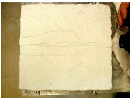
Bild 9: Versuch C 6 nach Ende; Fugenriss Nr. 1 in der Mitte mit den beiden Parallelrissen oben und unten
