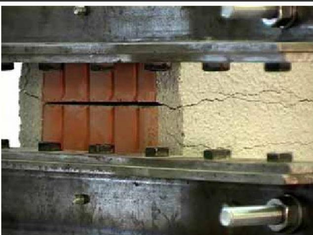
Bild 8: Leichtputz Typ I mit Armierungsgewebe in der oberen Hälfte; Zustand maximaler Dehnung kurz vor Versuchsende
