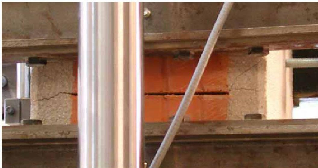
Bild 14: Nach Entstehen der Primärrisse direkt über der Fuge bildete sich rechts ein Nebenriss im Unterputz, der schräg nach oben von der Fuge zur Armierungslage verläuft.
