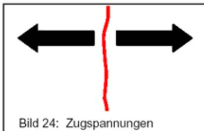
Bild 24: Zugspannungen
