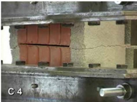
**Bild 6:** Erstriss über der Fuge; Armierungsgewebe in der oberen Hälfte eines Leichtputzes Typ I
