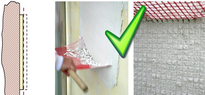
Das überstehende Armierungsgewebe wird mit einem Besenstiel eingerollt und mit einem kräftigen Ruck senkrecht von der Fläche abgezogen. Bleibt der Kleber am Untergrund haften, so ist die Abreißprobe positiv ausgefallen.
