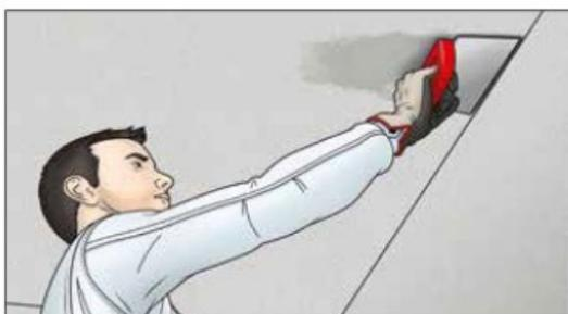
*Trennschnitt mit Stucksäge*
